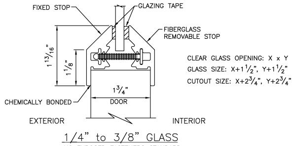
NO EXPOSED FASTENERS STANDARD SECURITY FASTENERS AVAILABLE CONTACT FACTORY FOR DETAILS
